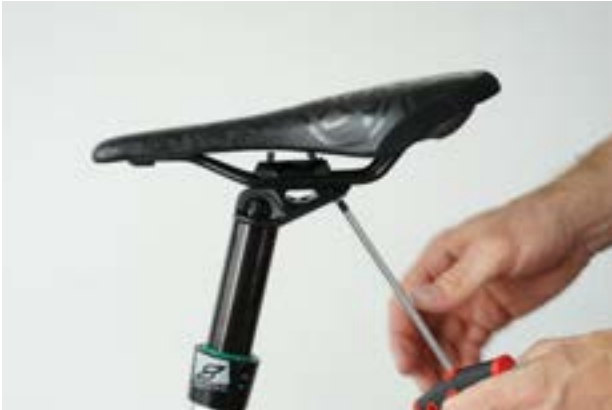
Figura 101: Aflojamiento del tornillo trasero
