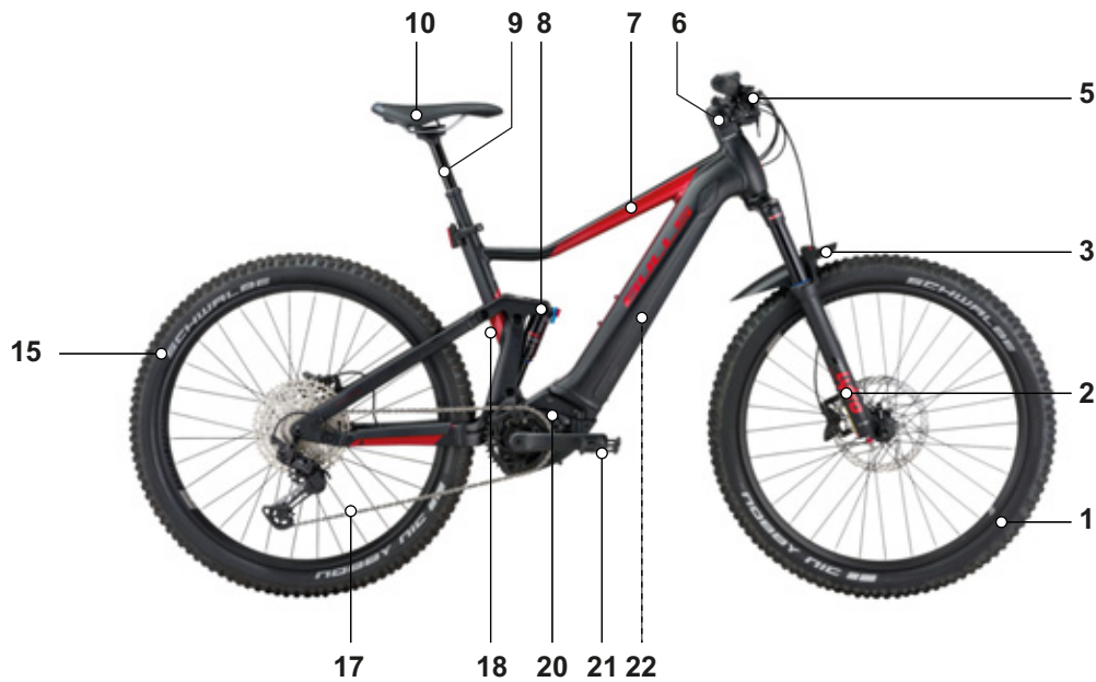
Figura 2: Pedelec visto desde el lado derecho, ejemplo BULLS Aminga EVA TR 1
