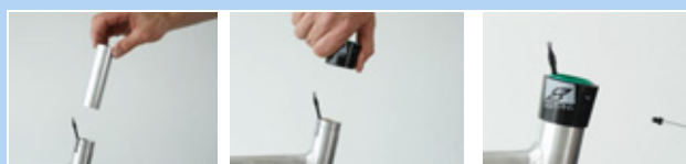
Figura 217: Montaje del casquillo deslizante y del manguito exterior
