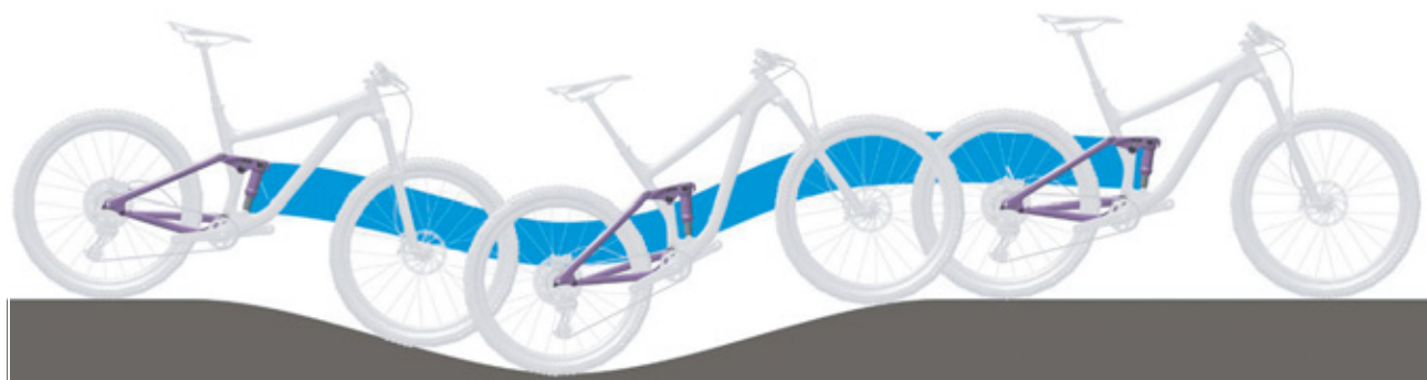
Figura 22: Condición óptima de marcha del amortiguador de la horquilla trasera sobre un terreno accidentado
