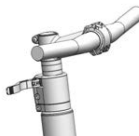
Figura 173: All Up con palanca tensora de la potencia abierta
