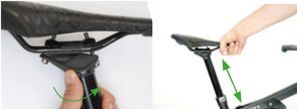
Figura 95: Ajuste de la altura de la tija de sillín
