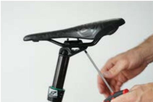
Figura 105: Aflojamiento del tornillo trasero
