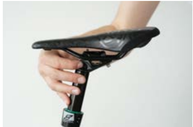
Figura 106: Ajuste de la inclinación del sillín en la rueda de ajuste
