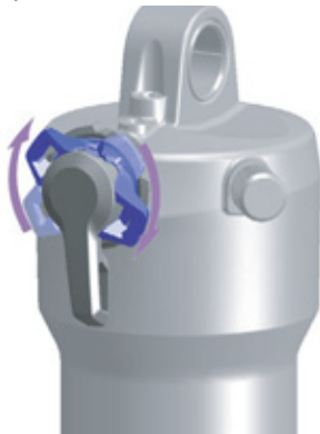
Figura 149: Ajuste para un regulador de niveles de presión más duro
