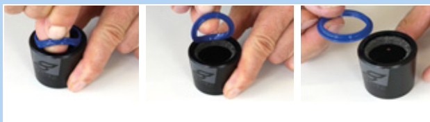
Figura 238: Extracción del rascador
