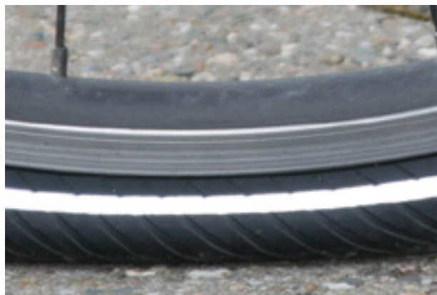
Figura 117: Presión de inflado demasiado baja
