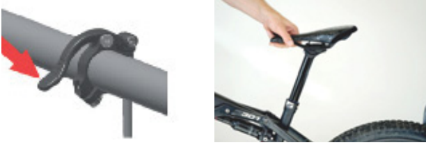
Figura 94: Extracción del muelle de compresión de gas hidráulico
