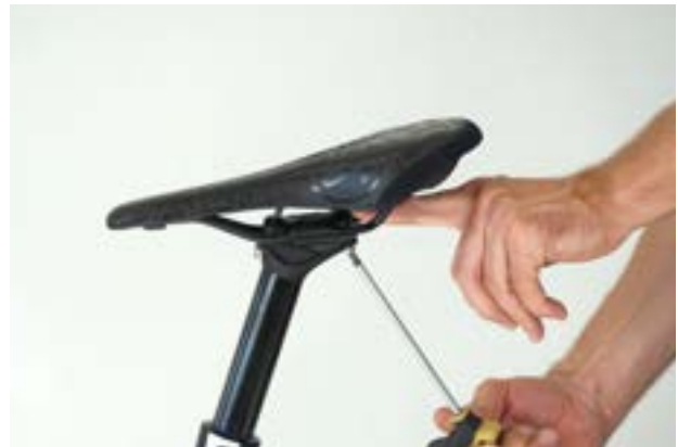
Figura 99: Aflojamiento del tornillo trasero
