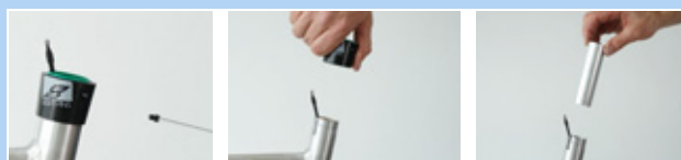
Figura 201: Desmontaje del manguito exterior y del casquillo deslizante
