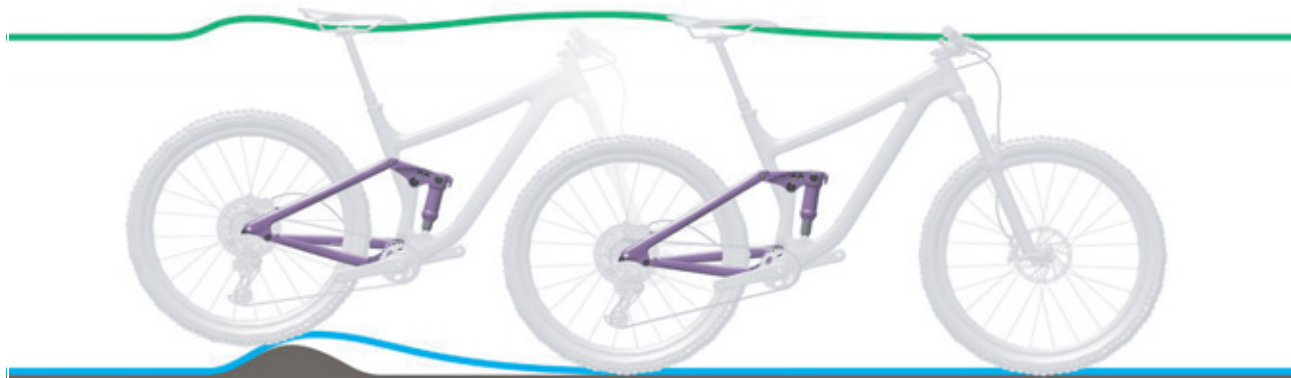
Figura 277: Amortiguación del amortiguador de la horquilla trasera demasiado dura en caso de irregularidades
