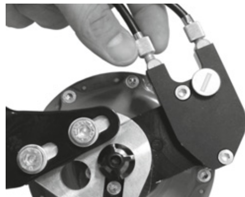
Figura 186: Las versiones de bujes Rohloff con activación de cambio externa tienen los dispositivos de ajuste de tensión en la caja de cables que se encuentra en el lado izquierdo
