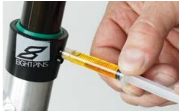
Figura 178: Lubricación del tubo de la tija de sillín
