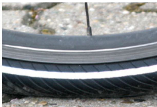
Figura 116: Presión de inflado correcta. La cubierta apenas está deformada bajo la carga del peso corporal
