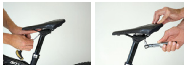
Figura 100: Fijación del tornillo delantero y trasero
