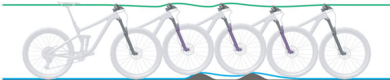
Figura 257: Descompresión demasiado lenta de la horquilla de suspensión
