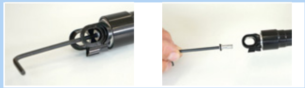
Figura 209: Desenroscar la tapa de la válvula
