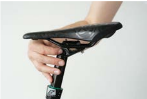
Figura 102: Ajuste de la inclinación del sillín en la rueda de ajuste
