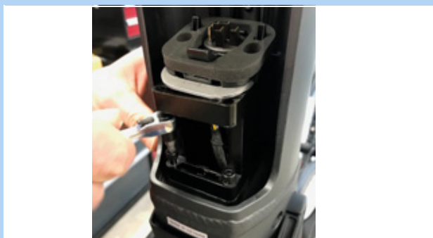
Figura 56: Retirada de los tornillos hexagonales de 4 mm
