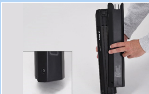
Figura 67: Desplazamiento de la cubierta de la batería sobre la batería
