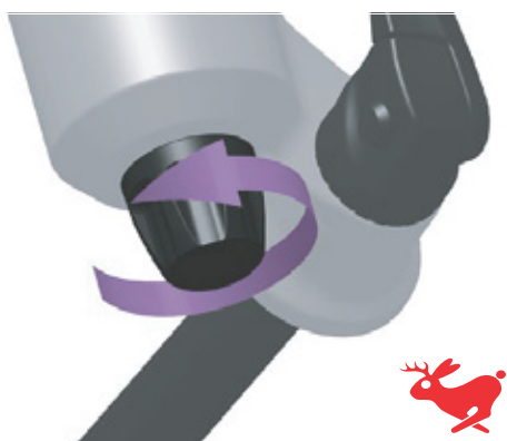
Figura 266: Tornillo de niveles de tracción en dirección al conejo
