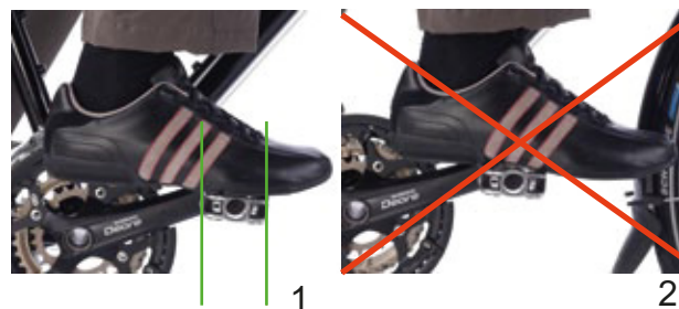
Figura 160: Posición correcta (1) e incorrecta (2) del pie sobre el pedal
