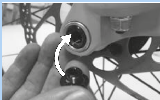
Figura 72: Inserción de la palanca de cierre rápido en el eje
