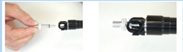
Figura 210: Enroscar el adaptador de la válvula
