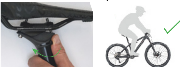
Figura 96: Apriete del eje de la tija de sillín
