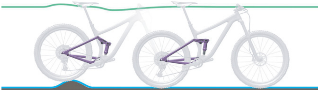
Figura 145: Condición óptima de marcha del amortiguador de la horquilla trasera en caso de irregularidades
