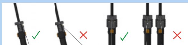
Figura 220: Cable Bowden correcto e incorrecto
