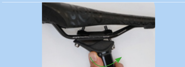
Figura 244: Apertura del ajuste de altura
