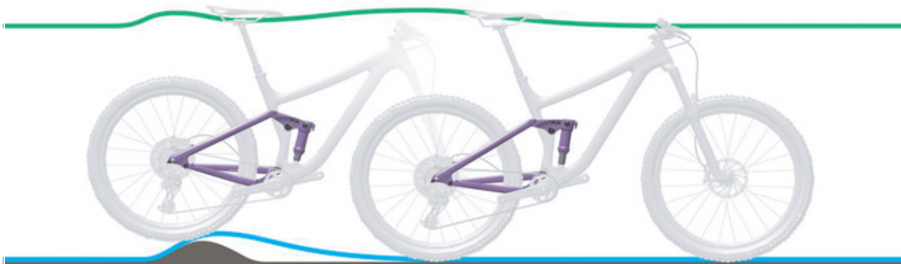
Figura 285: Amortiguación del amortiguador de la horquilla trasera demasiado dura en caso de irregularidades
