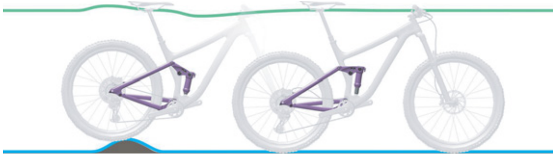
Figura 18: Condición óptima de marcha del amortiguador de la horquilla trasera en caso de irregularidades
