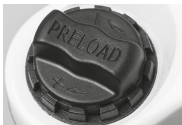
Figura 52: Manopola di regolazione dell'escursione negativa della sospensione sulla corona della forcella ammortizzata
