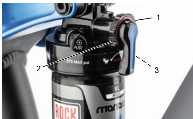
Figura 67: Regolazione della rigidità dell'ammortizzatore a stadi di trazione con la manopola di regolazione (1) dell'ammortizzatore del carro posteriore
