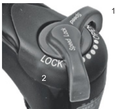
Figura 64: Regolatore della compressione Suntour con posizioni OPEN (1) e LOCK (2)
