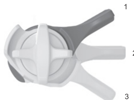
Figura 62: Regolatore della compressione FOX sull'ammortizzatore del carro posteriore con le posizioni APERTO (1), MEDIO (2) e RIGIDO (3)
