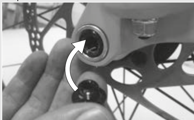
Figura 22: Applicazione della leva del bloccaggio rapido nel perno
