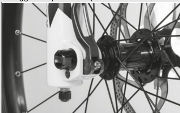
Figura 30: Corretta posizione della leva di serraggio
