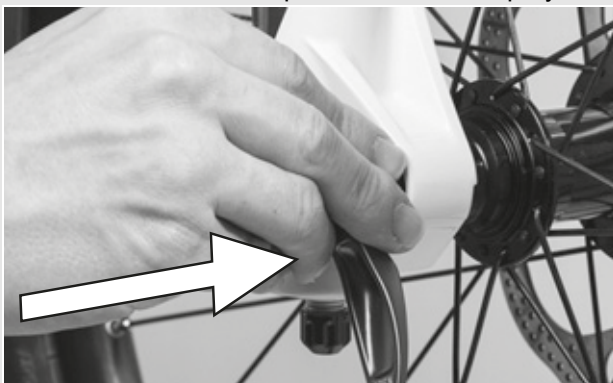
Illustration 37 : Enfoncez l'attache rapide
