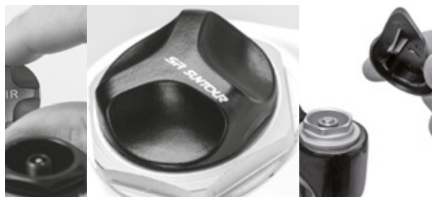
Illustration 56 : Divers modèles de couvercles vissés
