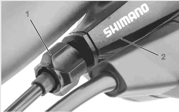
Illustration 81 : Douille de réglage (1) du changement de vitesse à un câble actionné par câble avec boîtier de manette de vitesse (2), exemple
