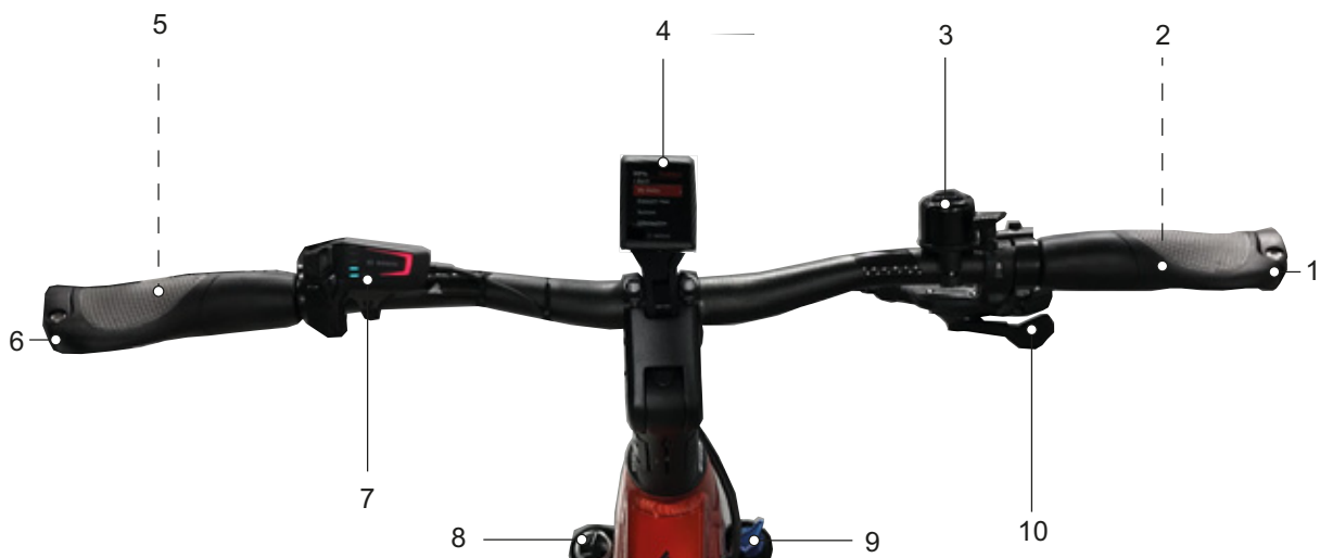
Afbeelding 39: Detailaanzicht stuur met BOSCH Kiox300, voorbeeld
