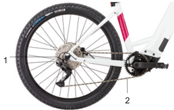
Afbeelding 32: Schema kettingaandrijving met derailleur
