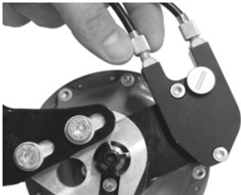
Afbeelding 140: Bij Rohloff naafversies met externe schakelaansturing zit de kabelafsteller op de kabelbox aan de linkerkant.
