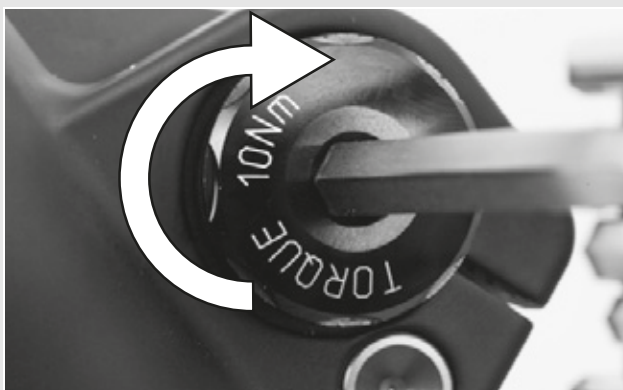
Afbeelding 32: Aangebrachte as vastdraaien
