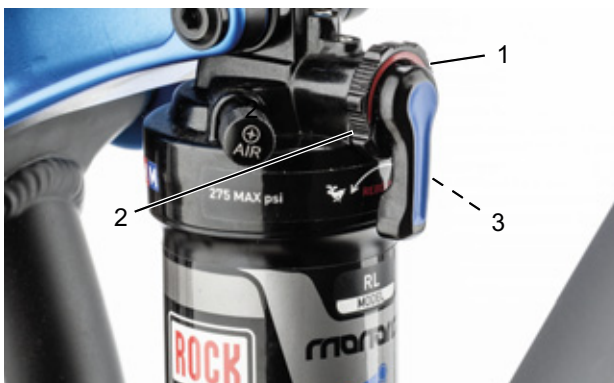
Afbeelding 82: Hardheid van de trekdemper afstellen met het afstelwiel (1) van de achterbouwdemper
