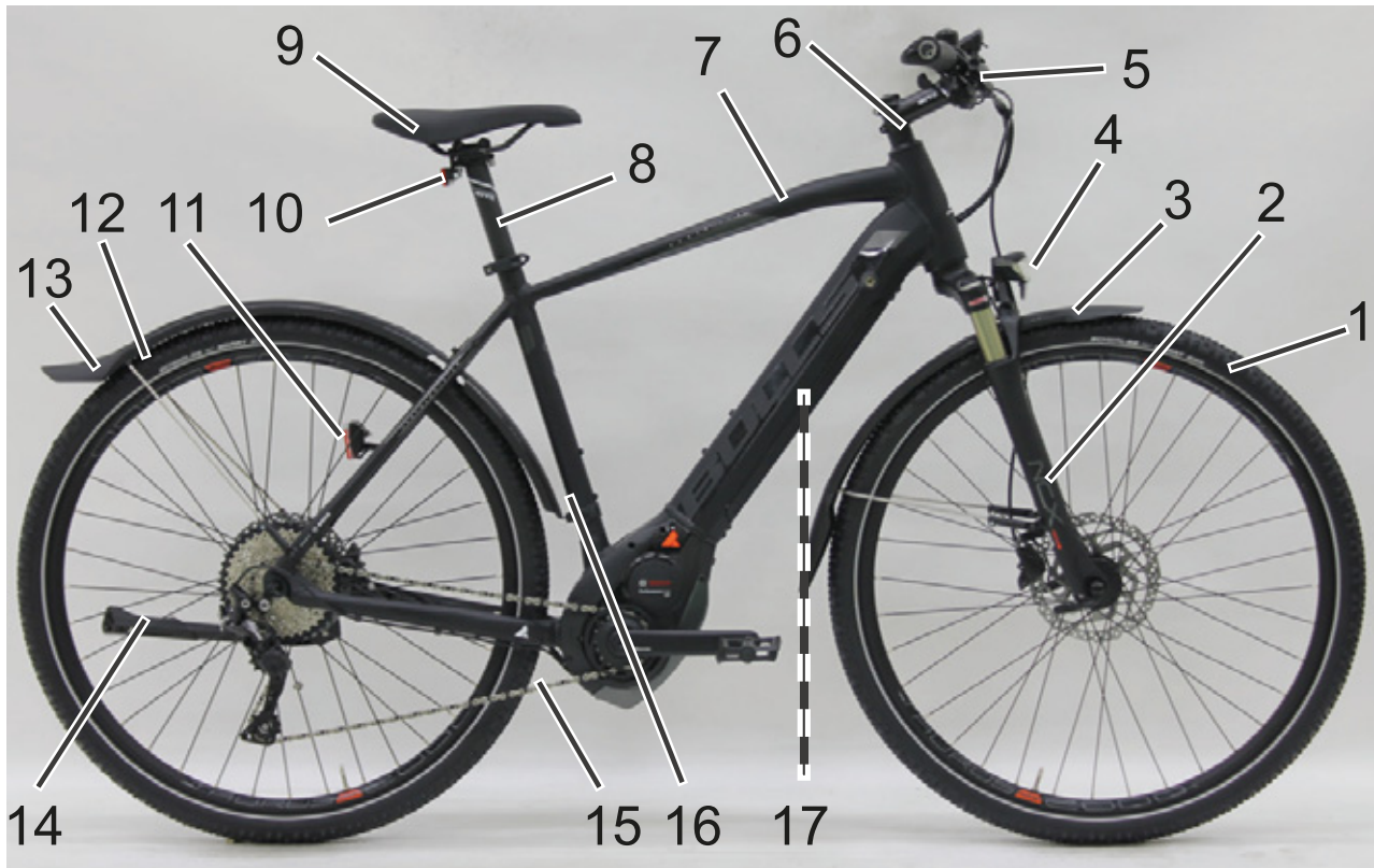
Afbeelding 2: Pedelec van rechts gezien, voorbeeld Bulls Cross Rider
