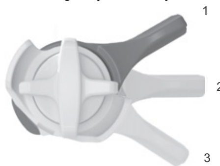
Afbeelding 77: FOX-drukdemperafsteller op de achterbouwdemper met de standen OPEN (1), MIDDEL (2) en HARD (3)
