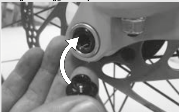
Afbeelding 30: Snelspanhendel in as schuiven
