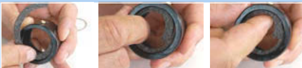
Afbeelding 448: Vilten ring inleggen
