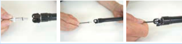
Afbeelding 419: Ventieldop van de patroon aanbrengen
