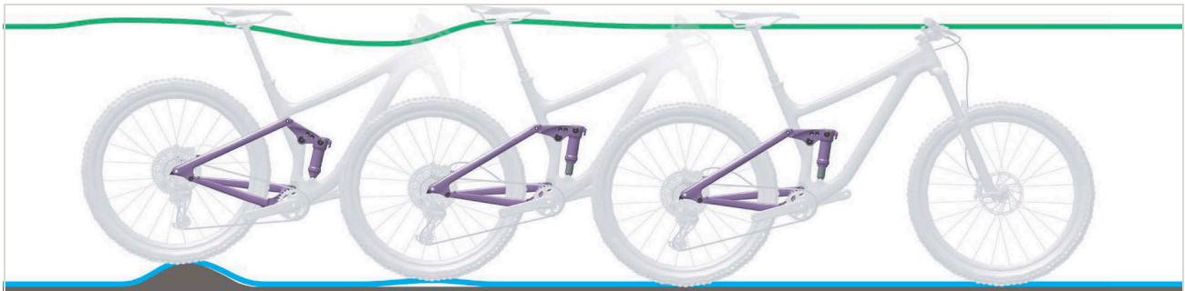
Afbeelding 510: Te snel uitveren van de achterbouwdeemper
