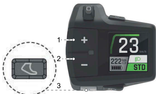
Afbeelding 337: Locatie plus- (1), min- (2) en duwondersteuningstoets (3)
