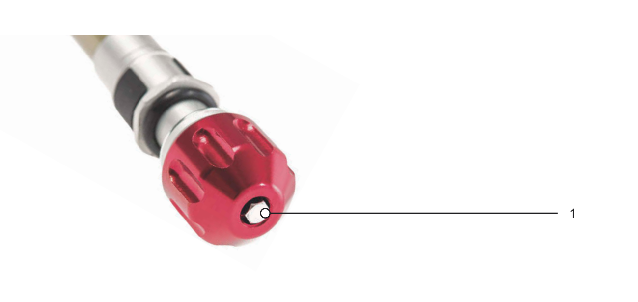
Afbeelding 471: Voorbeeld SR SUNTOUR trekdemperafsteller (vork) (1)
