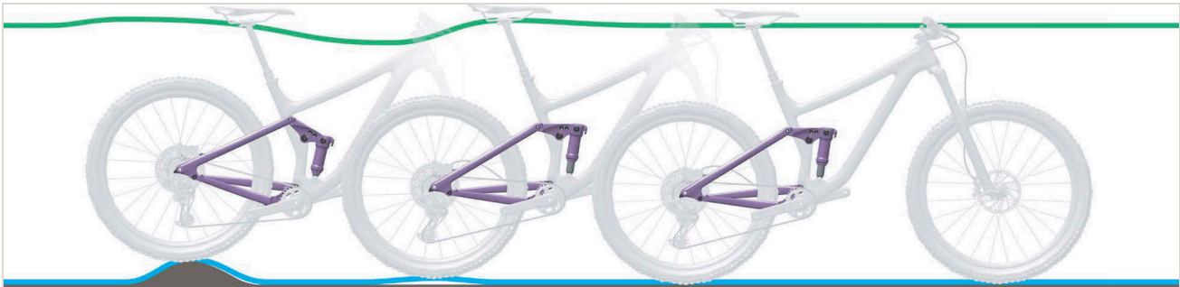
Afbeelding 502: Te snel uitveren van de achterbouwdeemper
