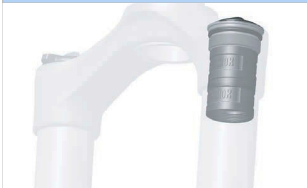
Afbeelding 238: Twee Bottomless Tokens in DebonAir vering
