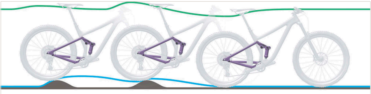
Afbeelding 496: Te langzaam uitveren van de achterbouwdemper
