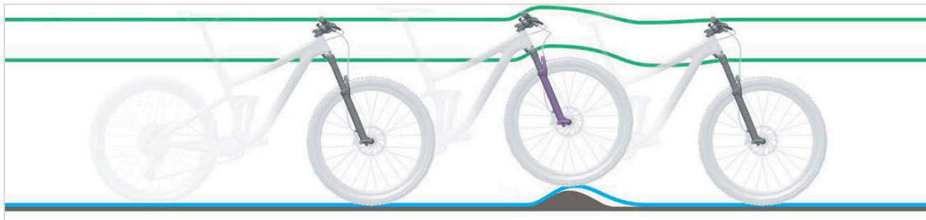
Afbeelding 482: Te harde demping de verende voorvork bij oneffenheden
