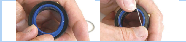
Afbeelding 449: Afstrijker inleggen en bevestigen
