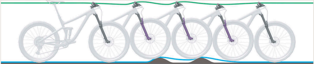
Afbeelding 486: Te langzaam uitveren van de verende voorvork
