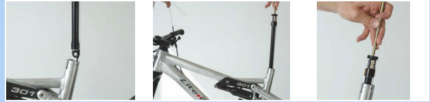
Afbeelding 428: Ventioldop van de patroon aanbrengen
