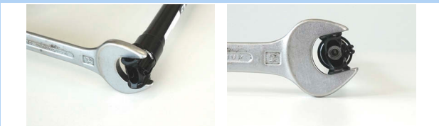
Afbeelding 421: Borgen tegen verdraaien
