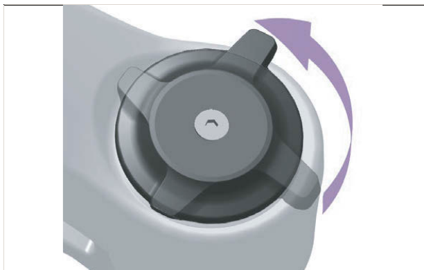
Afbeelding 483: Drukdemperafsteller zachter afstellen
