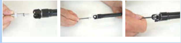
Afbeelding 423: Ventieldop van de patroon aanbrengen
