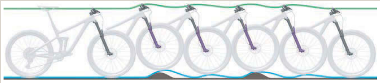
Afbeelding 484: Te snel uitveren van de verende voorvork
