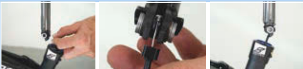
Afbeelding 458: Zadelpen ophangen en inschuiven
