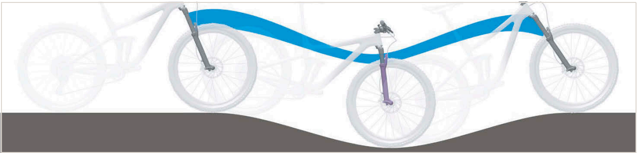
Afbeelding 488: Te zachte vering van de verende voorvork bij kuilen
