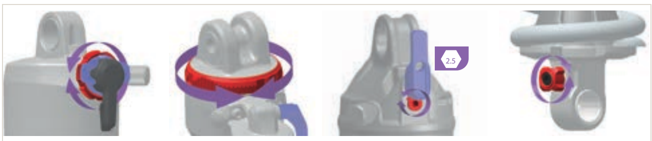
273. ábra: A húzófokozat-beállító (hátsó lengéscsillapító) (piros) elhelyezkedése és alakja a modelltől függ
