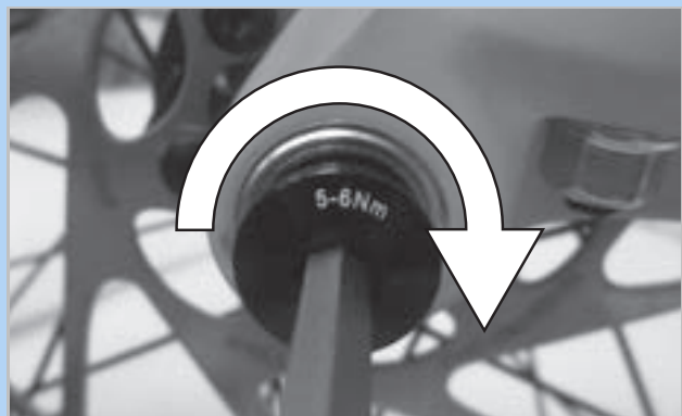
77. ábra: A rögzítőcsavar meghúzása
