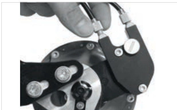
225. ábra: Külső váltóvezérléssel rendelkező ROHLOFF agyváltozatok húzásbeállítója a kötéldobozon van, ami a bal oldalon található
