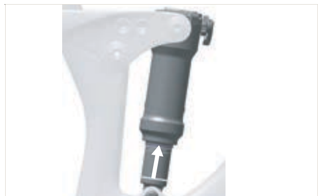
144. ábra: O-gyűrű eltolása a hátsó lengéscsillapítón
