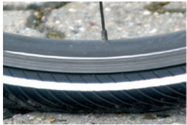
119. ábra: Helyes töltőnyomás. A gumibroncs alakja a testsúly terhe alatt alig változik
