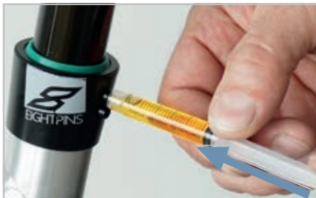
196. ábra: EIGHTPINS nyeregcső kenése
