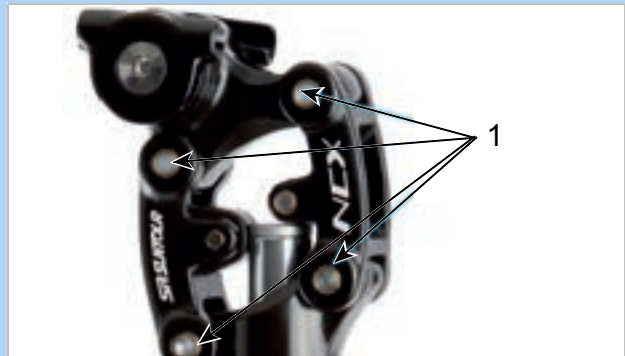
230. ábra: SR SUNTOUR rugós nyeregcső kenőpontjai
