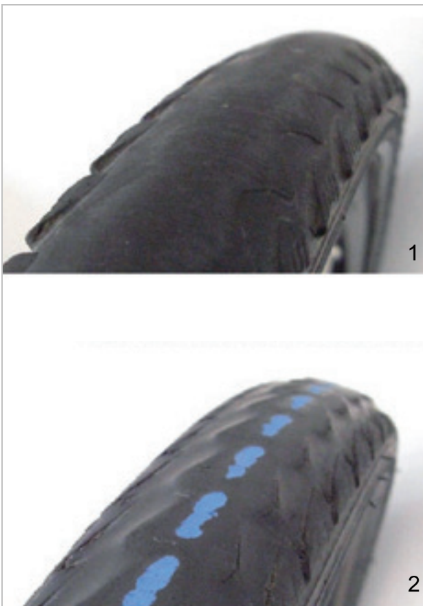
198. ábra: Profil nélküli gumiabroncs, amelyet cserélni lehet (1), és gumiabroncs áttetsző defektvédelemmel (2), amelyet cserélni kell
