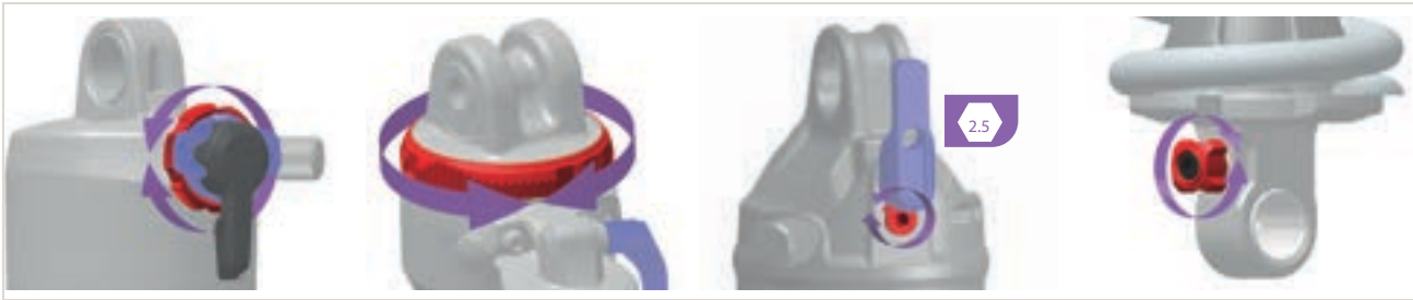
153. ábra: A húzófokozat-beállító (hátsó lengéscsillapító) (piros) elhelyezkedése és alakja a modelltől függ
