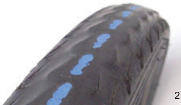
Afbeelding 143: Een band zonder profiel waarmee nog kan worden gereden (1), en een band met zichtbare anti-leklaag (2), die moet worden vervangen
