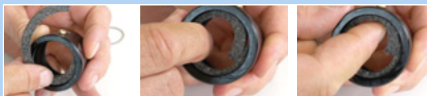
Afbeelding 169: Vilten ring inleggen
