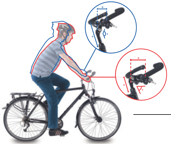
Afbeelding 98: Stadsfiets- (blauw) en toerfietsstand (rood) door verandering van de hoek
