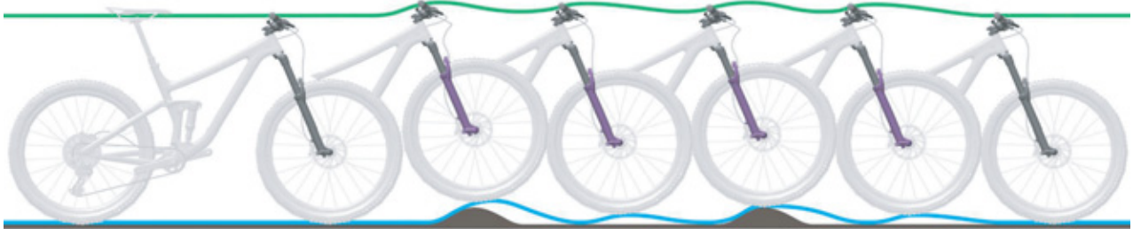
Afbeelding 218: Te snel uitveren van de verende voorvork
