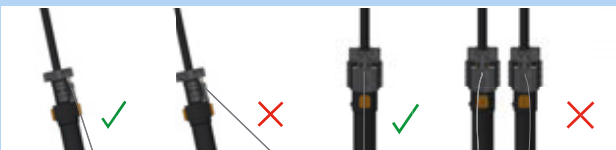
Afbeelding 183: Correcte en verkeerde bowdenkabel
