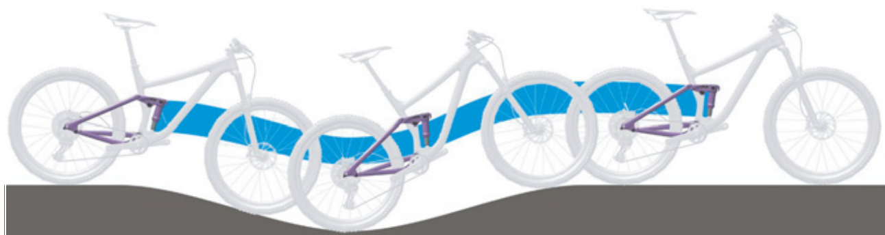
Figura 21: Comportamento di marcia ottimale dell'ammortizzatore del carro posteriore su un terreno con dossi
