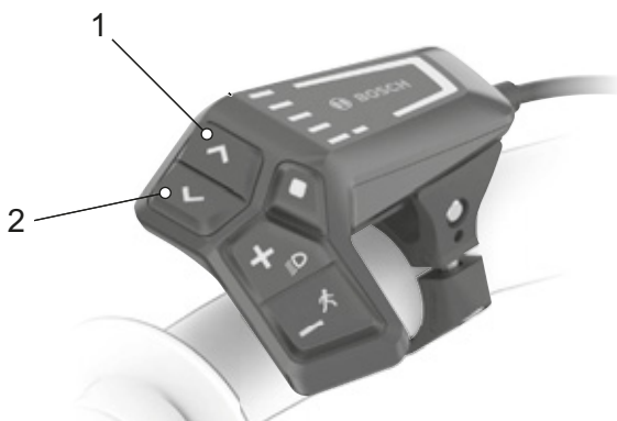
Figura 139: Ubicazione del tasto di aumento della luminosità (2) e del tasto di diminuzione della luminosità (1)
