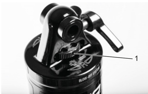
Figura 250: Regolatore del rebound Suntour (1) sull'ammortizzatore del carro posteriore
