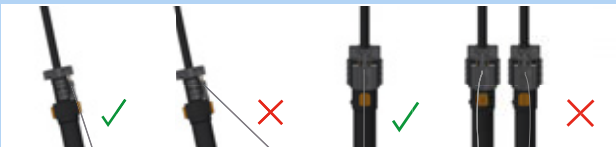
Figura 196: Cavo meccanico corretto ed errato
