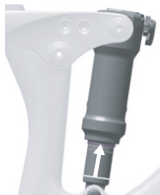
Figura 113: Spostamento dell'O-ring sull'ammortizzatore del carro posteriore
