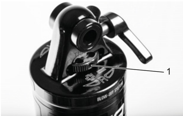
Figura 248: Regolatore del rebound Suntour (1) sull'ammortizzatore del carro posteriore
