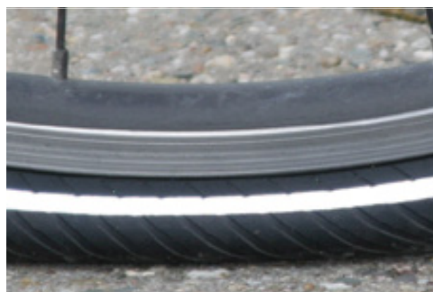
Figura 95: Pressione di gonfiaggio insufficiente
