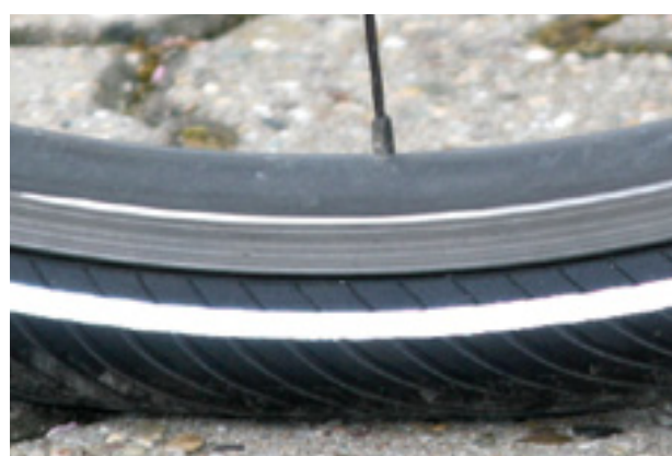
Figura 94: Corretta pressione di gonfiaggio. Lo pneumatico quasi non si deforma sotto il peso corporeo
