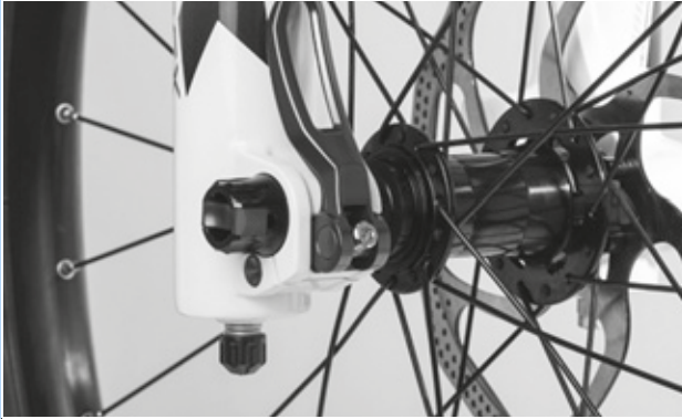
Figura 166: Regolazione della forza di serraggio del bloccaggio rapido
