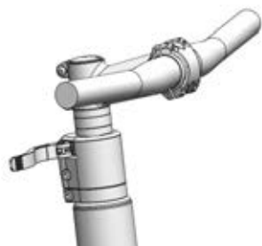
Figura 149: Esempio: All Up con leva di serraggio dell'attacco manubrio aperta
