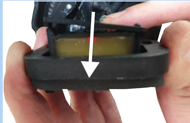
Figura 50: Fissaggio della clip
