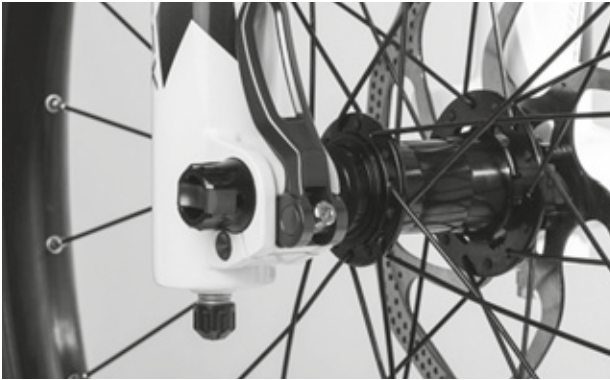
Figura 61: Corretta posizione della leva di serraggio
