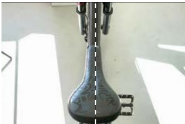
Figura 71: Posizionamento della sella in direzione di marcia
