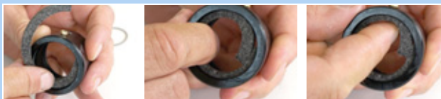
Figura 182: Applicazione dell'anello di feltro
