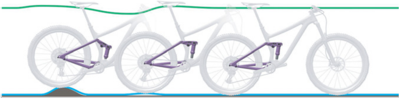
Figura 247: Corsa di estensione troppo veloce dell'ammortizzatore del carro posteriore
