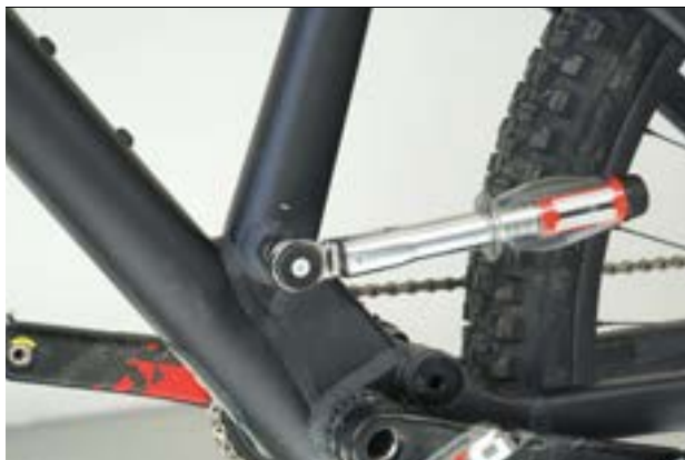
Figura 72: Serraggio dell'asse del canotto reggisella
