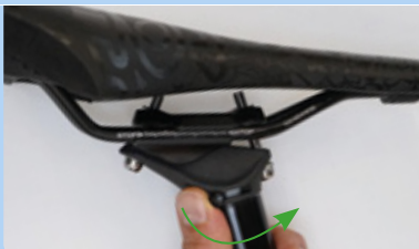
Figura 220: Apertura della regolazione in altezza
