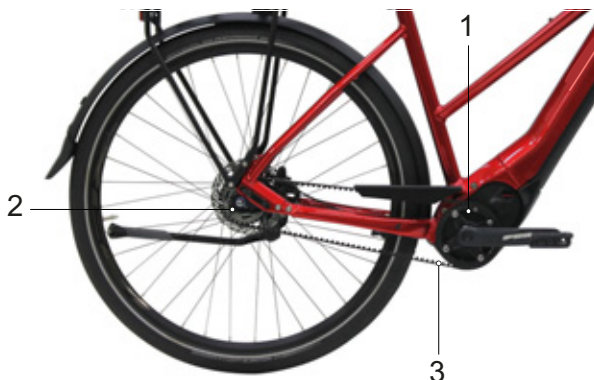
Figura 36: Schema della trasmissione a cinghia
