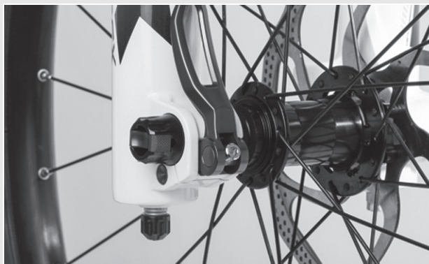
Abbildung 83: Spannkraft des Schnellspanners einstellen
