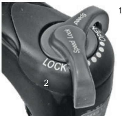
Abbildung 75: Suntour-Druckstufeneinsteller mit den Positionen OPEN (1) und LOCK (2)
