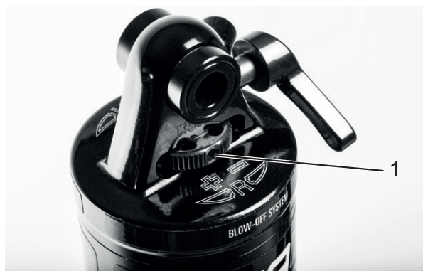
Abbildung 60: Suntour-Zugstufeneinsteller Rad(1) am Hinterbau-Dämpfer
